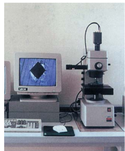
Ensayos automáticos de cementación (valores y curvas)
